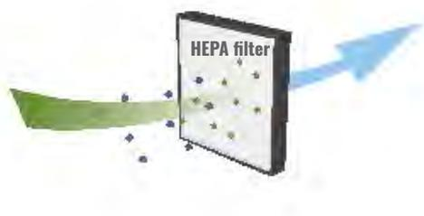
Una máquina que está bien diseñada puede decepcionar rápidamente si se utilizan filtros deficientes. Nuestros filtros True HEPA se ajustan al Estándar IEST 1.5 HEPA que demuestra una eficacia del 99,97% en el tamaño de 0.3 micrones. Además, nuestros filtros pueden capturar más del 97,8% de contaminantes a 0.1-0.15 micras, según los datos de los test de los Laboratorios IBR.
